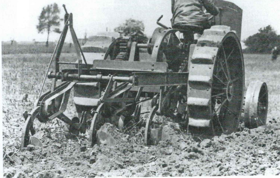
Det första danska företaget som gav sig in i traktorbranschen var Köpenhamns-baserade Tuxner & Hammerich med motorplogen Tuxham år 1915. Tändkulemotor på 18 hästar. Transmissionen vid bakhjulet ser lömsk ut.
